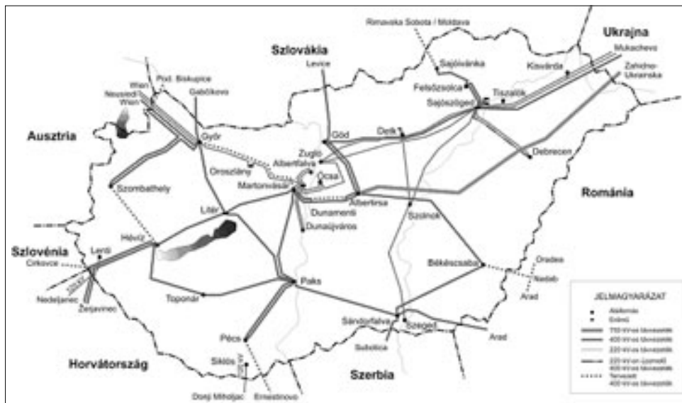
3. ábra. A magyar átviteli hálózat 2006-ban a nemzetközi összeköttetésekkel és a tervezett fejlesztésekkel
